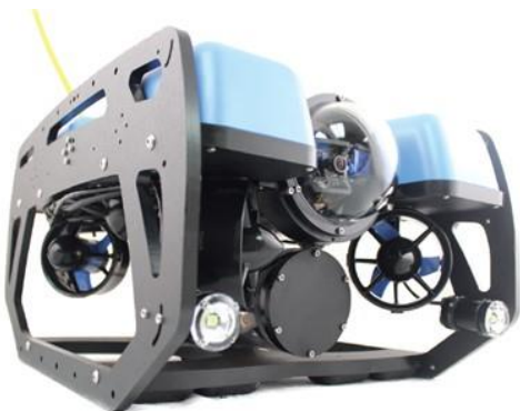
Figur 2.3. ROV af fabrikatet Blue ROV2, der blev brugt til de visuelle verifikationer.
